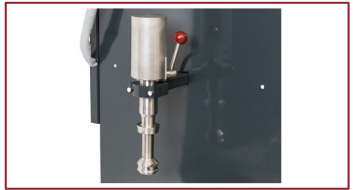
图 3: 重新设计了的取样模块 SAM 和改进了的热电偶支架
