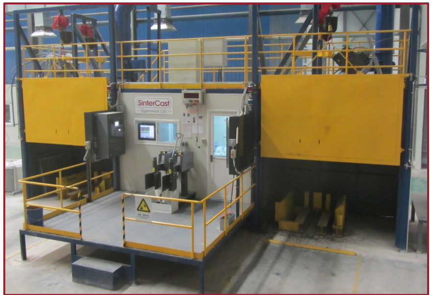
图 1：系统 4000 增强型前处理和校正处理站
