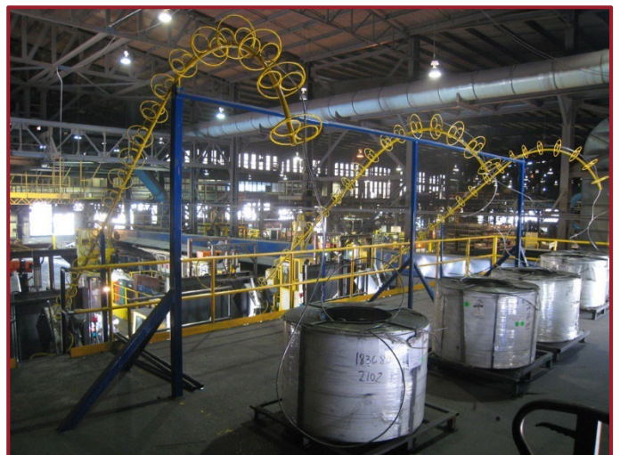
图 6: 用于前处理和校正处理的多个喂线机
