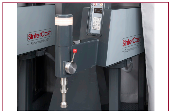
Ombyggd SAM med förbättrad termoelementhållare
