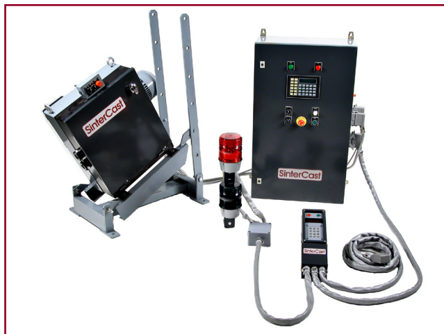
En komplett trådmatare innefattar trådmatarhuvud, styrskåp, operatörsskåp och signallampa
