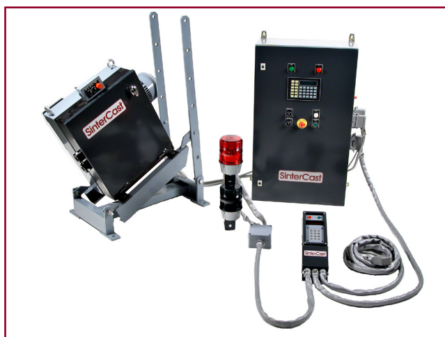
En komplett trådmatare innefattar trådmatarhuvud, styrskåp, manöverpanel och signallampa
