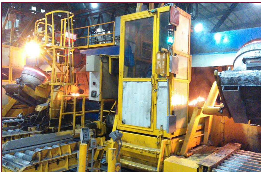
System 3000 Plus: parallellgjutning av Ford 2.7 liter V6-bensinmotorblock vid Tupy Saltillo-gjuteriet i Mexiko (Med tillstånd av Tupy)
