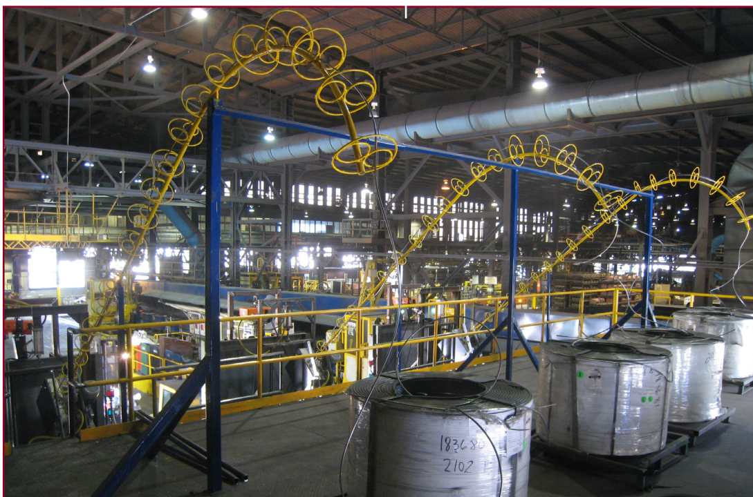
System 3000 Plus: flera trådmatare för basbehandling och korrigerig vid Tupy Saltillo-gjuteriet i Mexico (Med tillstånd av Tupy)
