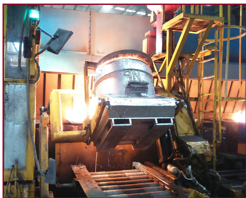
Figur 1: Tillsammans kombinerar Ladle Tracker™- och Cast Tracker™-teknologierna gjutformens och gjutformskärnans historik med metallsmältans historik, vilket ger fullständig spårbarhet.
