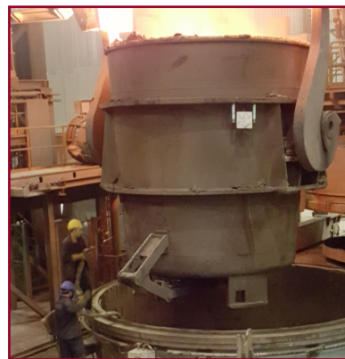
Figur 3: RFID-märke eller optisk skylt kan användas för att identifiera skänkar.
