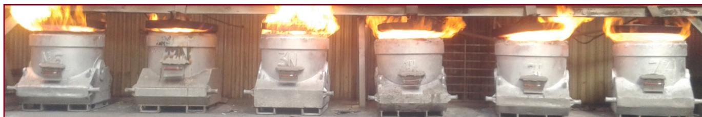
Figur 6: RFID-märken eller 2D optiska skyltar spårar skänkar genom processen och kopplar varje gjutform till den smälta metallens historik.
