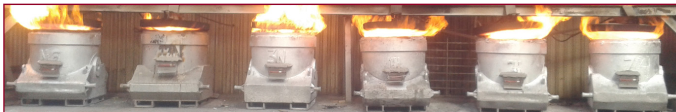
RFID-märken eller 2D optiska skyltar följer skänkar genom processen och kopplar varje gjutform till den smälta metallens historik.
