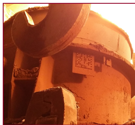
RFID-märken eller 2D optiska matrisplattor (på bild) kan användas för att identifiera skänkar.
