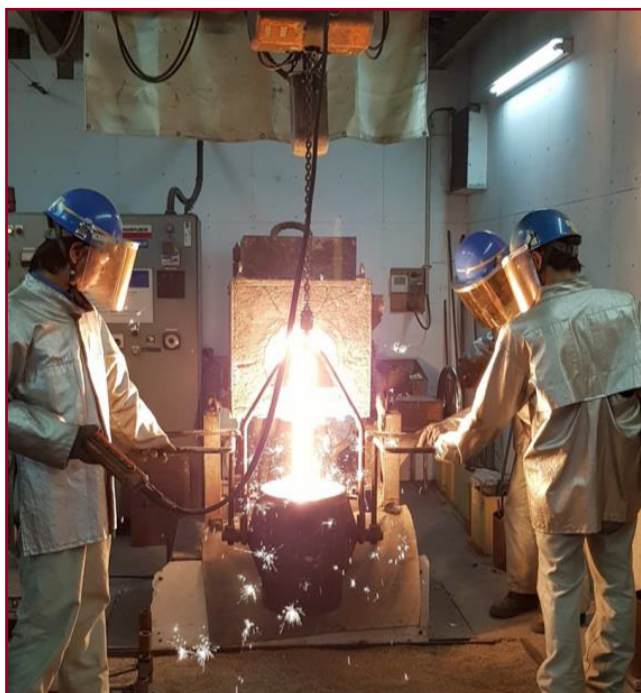
Ett Mini-System 3000 installerat i Kimura-gjuteriet i Japan för CGI-produktutveckling, kompletterar Kimuras prototyp och nichvolymproduktion med 3D-printad sand och med SinterCasts processtyrningskunnande inom CGI.
