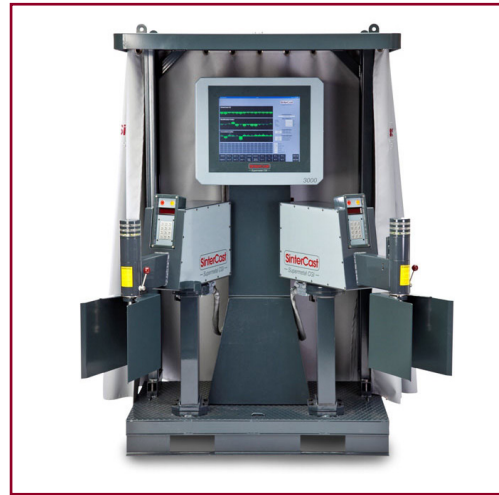
Helautomatiska System 3000 med två provtagningsmoduler
