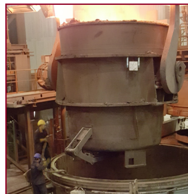
RFID-märken eller 2D optiska matrisplattor (på bild) kan användas för att identifiera skänkar.
