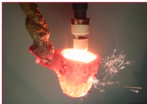
SinterCast provtagning genom nedsänkning
