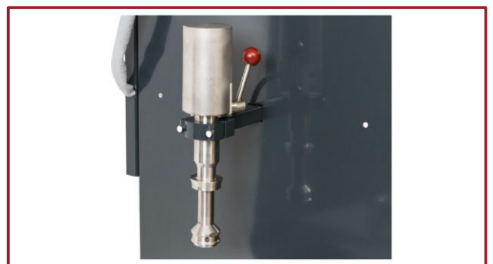
Figura 3: SAM reprojetoado com suporte Termopar otimizado
