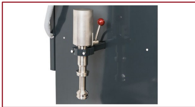
Figura 3: SAM reprojetoado com suporte Termopar otimizado
