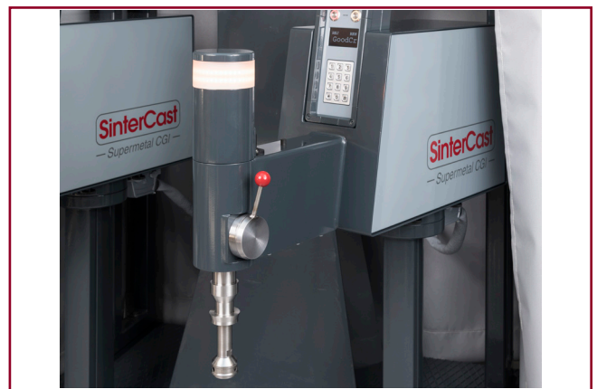
Ombyggd SAM med förbättrad termoelementhållare
